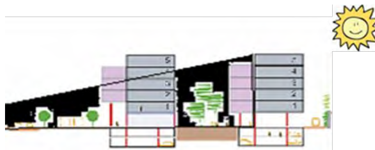
Exemple d'implantation de bâtiments à éviter du fait de la création d'une ombre portée
