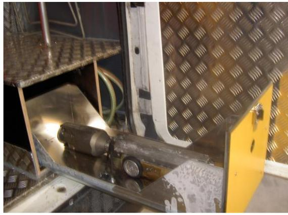
Figure 1 : matériel d'inspection vidéo
