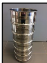
Tamis à trous ronds de 40cm de diamètre conformes ISO 3310-2 Mailles (mm) : 3,15 ; 8 ; 16 ; 31,5 ; 45 ; 63
